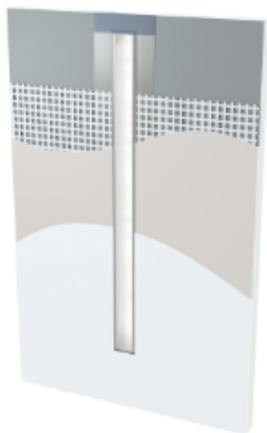
Fases da montagem com perfil GAUDI encastrado [1.pintura, 2.gesso, 3. rede e 4. placa de gesso]
